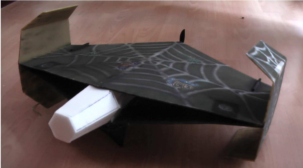
Der Pretender, mit starrem Seitenruder, eckiger Kabinenhaube und Heckantrieb.
