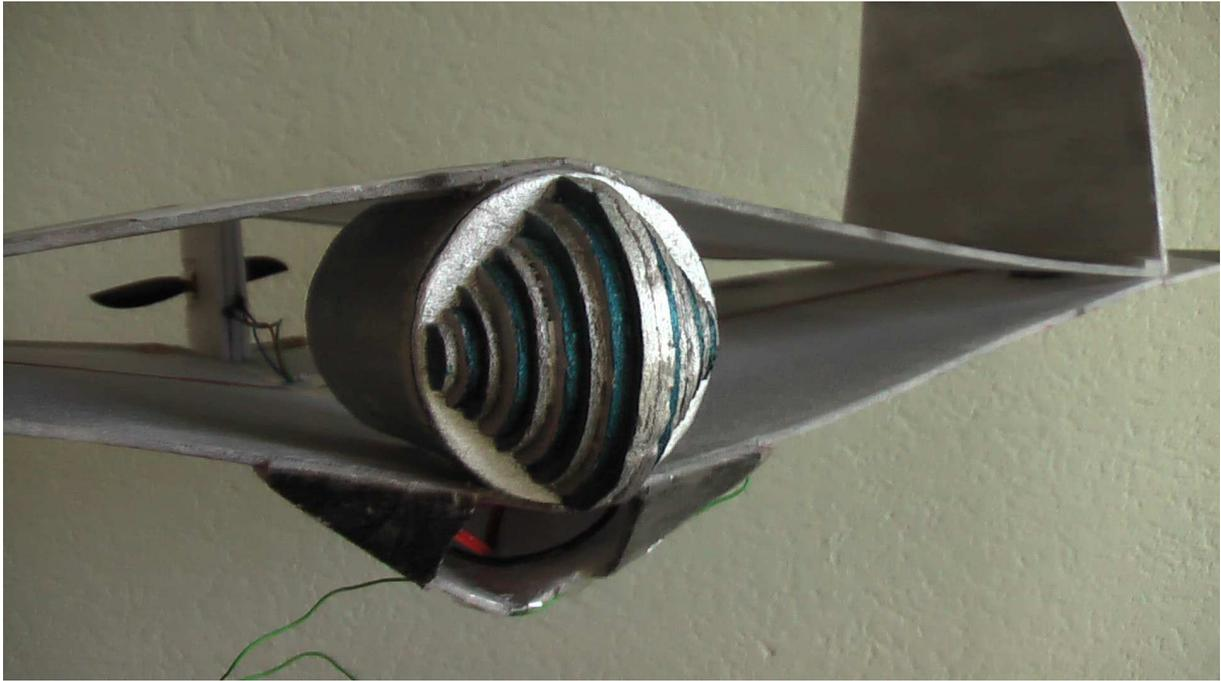
Das Modell Spy besitzt einen Heckantrieb und eine halbrunde Kabine, hinter der sich in einer Röhre, genügend Platz für Trimmgewichte und oder einen größeren Empfänger befindet.
