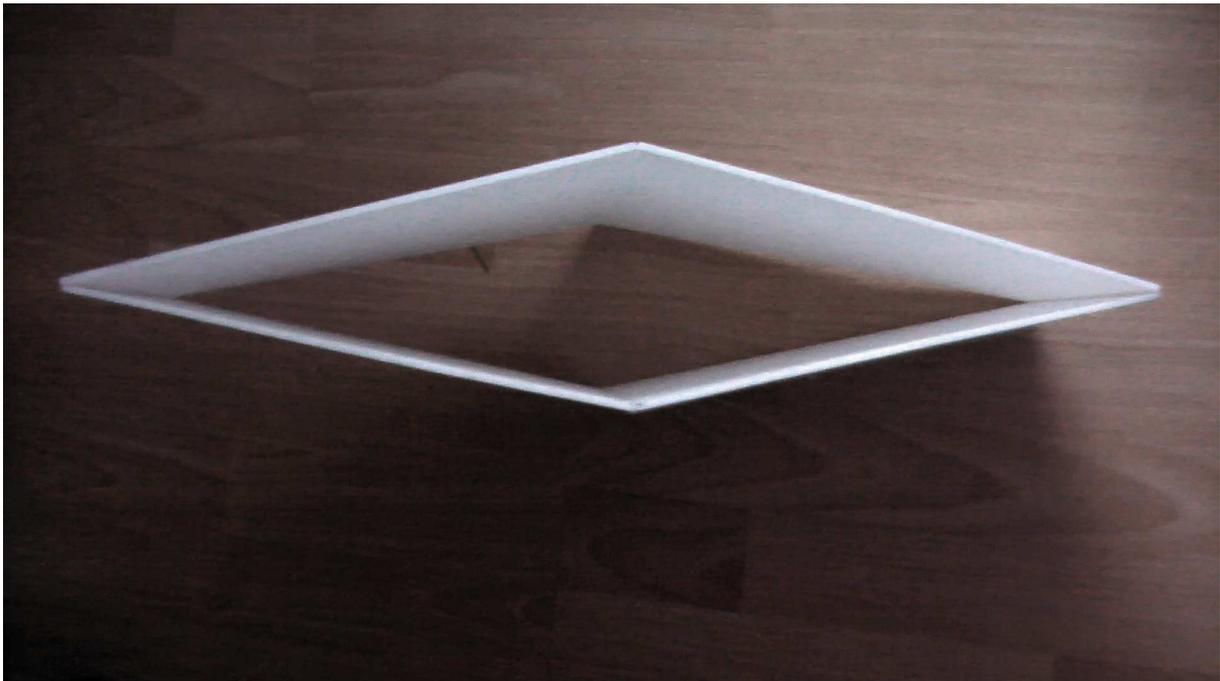
Beide Tragflächen übereinander legen, an den äußeren Enden mit Klebefilm fixieren und auf Parallelität prüfen.
