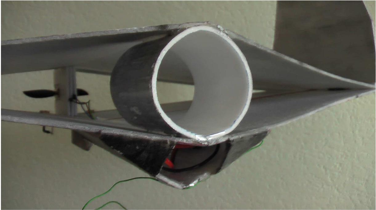
Die Aufnahme für die Kabinenhaube (Röhre) besteht aus einem rechteckigen Stück Depron. Die Maße für die Größe des Rechteckes sind wieder aus dem Plan direkt zu übernehmen.
