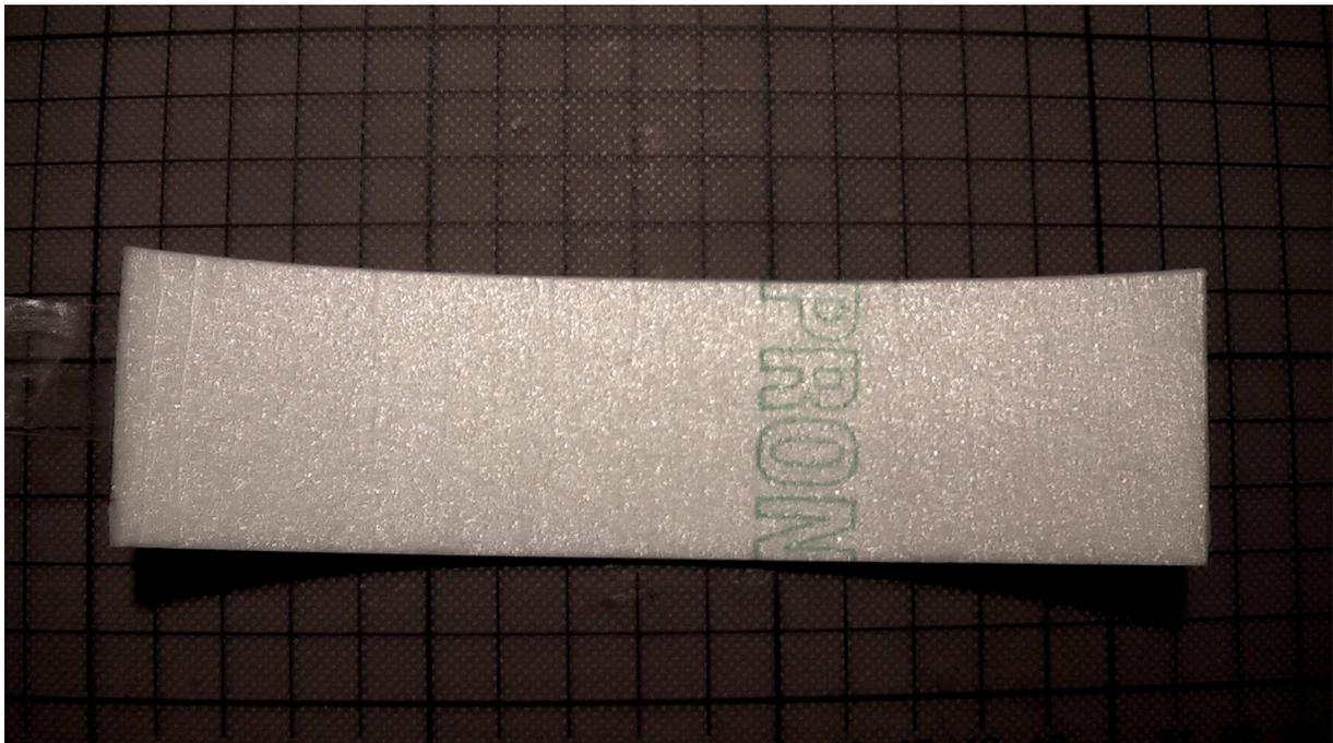
Achtung: Es ist wichtig dass die benötigten Rechtecke, eines für die Kabinenaufnahme und eines für die Kabinenhaube selbst, **quer zum Schriftzug Depron**, ausgeschnitten werden. Wird das Material in beschriebener Weise ausgeschnitten, lässt es sich leichter biegen. Damit das Formen zu einem Kreis noch einfacher wird, ist es ratsam das Material zu pressen. Am leichtesten geht dies mit einem Nudelholz, dass einfach unter starkem Druck über das Material gerollt wird.
