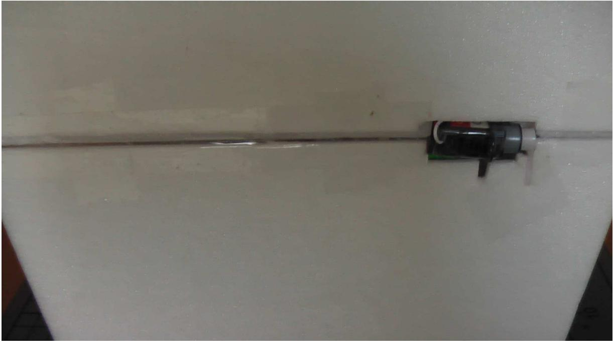
Auch der Servohebel wird vorerst nur mit Klebefilm mit dem Seitenruder verbunden
